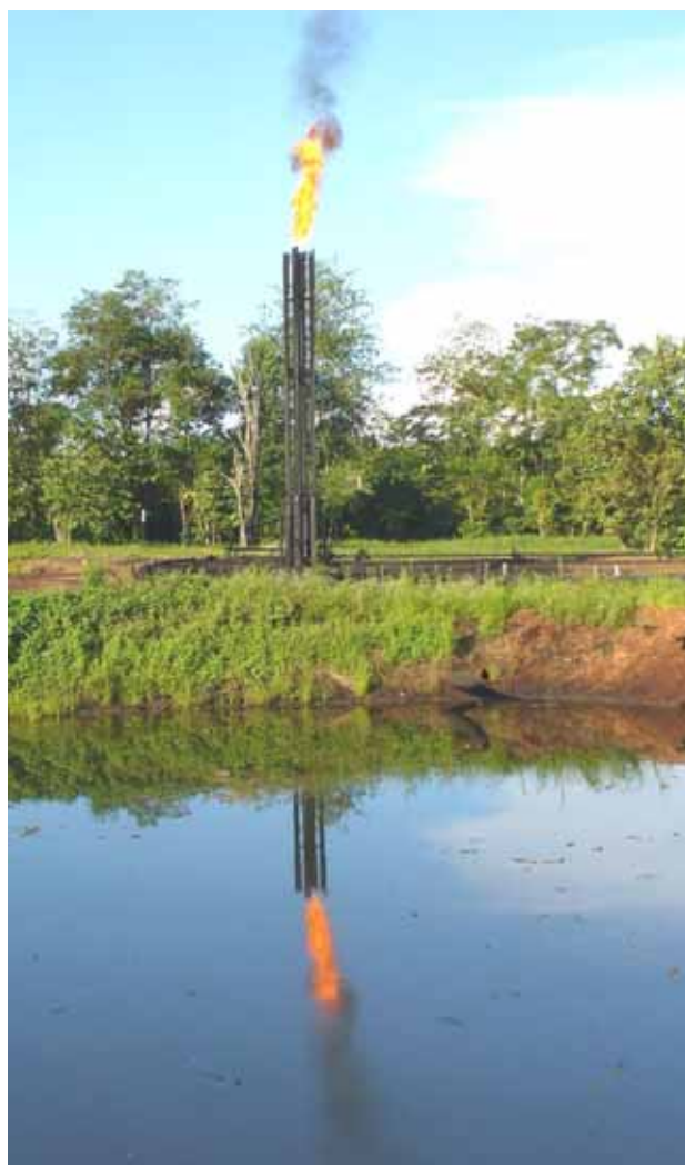
Die rußende Methangasfackel spiegelt sich in einem Becken mit Abwässern aus der Erdölförderung.
